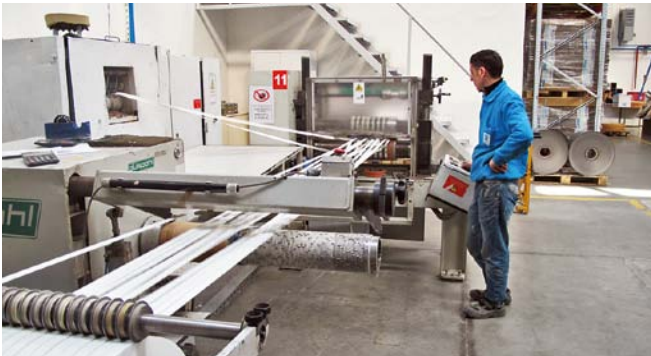
1 À côté du bâtiment administratif de Roma Plastik, il y a les ateliers de production et le nouveau bâtiment des ventes de EGGER. 2 Les bandes imprimées sont découpées dans la largeur des chants. 3 Les gros rouleaux empilés attendent l'impression.
