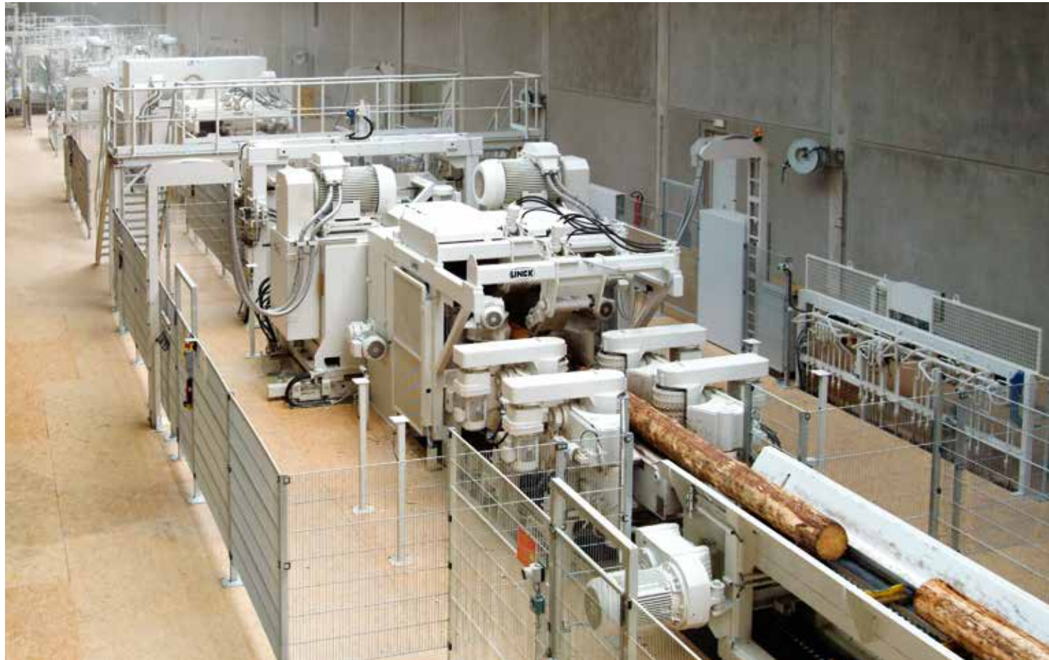
3 Toutes les 1,2 seconde, l'installation traite une grume comme l'illustre l'image ci-dessus.
