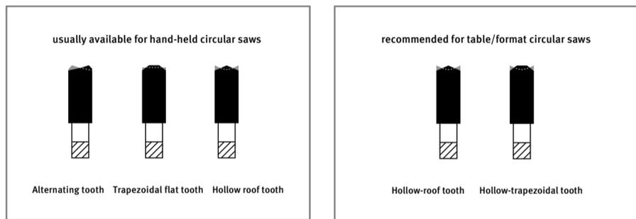
Recomenda-se lâminas com dentes planos trapezoidais para serrar painéis DecoWall com uma serra circular portátil. No entanto, recomenda-se lâminas com dentes de topo ocos ou dentes trapezoidais ocos para serras de mesa circulares. Quanto mais finos forem os dentes, menos lascas haverá. Deve serrar a uma velocidade de avanço reduzida em comparação com a serragem de madeira sólida.
