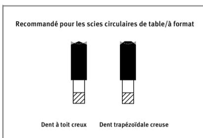
Les lames de scie à dents plates trapézoïdales sont recommandées pour le sciage des panneaux DecoWall à l'aide d'une scie circulaire manuelle. En revanche, les lames de scie à dent creuse ou dent trapézoïdale creuse sont recommandées pour les scies circulaires de table. Plus les dents sont fines, moins il y a d'éclats. Vous devez scier à une vitesse d'avance réduite par rapport au sciage de bois massif.
