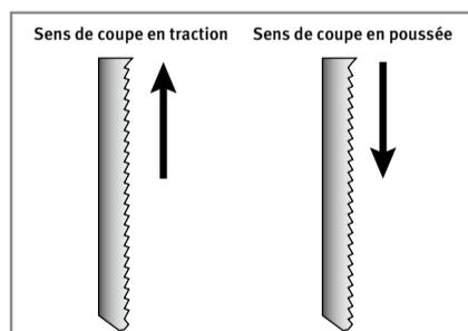
**Attention:** Le sens de coupe de la lame de scie utilisée doit être respecté.
